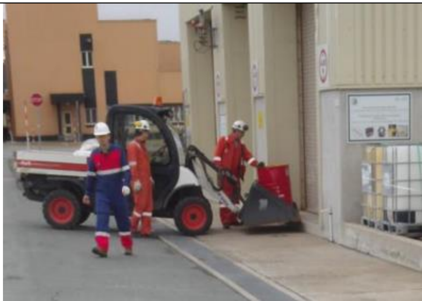
Фото 2. Незакрепленная бочка с отработанными ГСМ, транспортируемая погрузчиком Bobcat рядом со Зданием 10 (над системой ливневой канализации)
