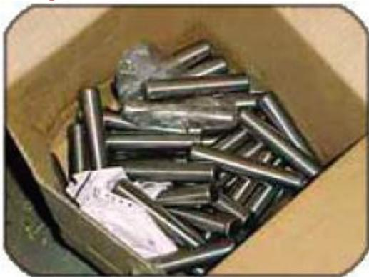
Упаковка, расположенная слева, содержит находящиеся в хаотичном порядке стальные шпильки. Эти детали не связаны вместе, а пустоты оставлены незаполненными. Шпильки следует завернуть, связать или положить в мешок, чтобы он выглядел в виде пучка. Затем коробку следует наполовину заполнить деннажем, а связанные детали положить в центр.
