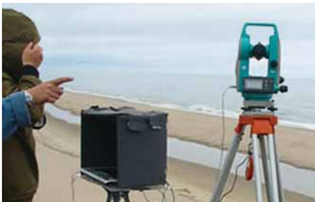
Компьютеризированная система слежения за серыми китами Computer aided theodolite whale tracking system
