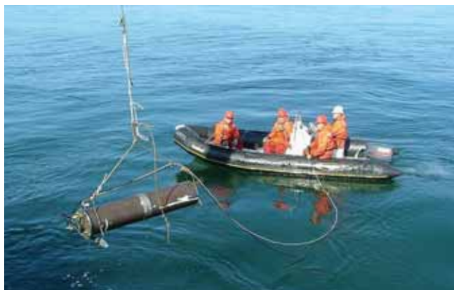
Подъем акустической станции Acoustic underwater recorder pickup
