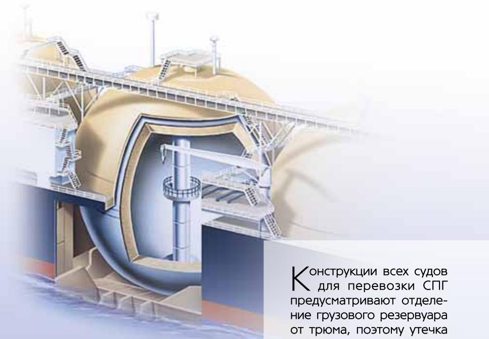
Конструкции всех судов для перевозки СПГ предусматривают отделение грузового резервуара от трюма, поэтому утечка из грузового резервуара возможна только при образовании нарушений целостности как минимум в трех корпусах.
