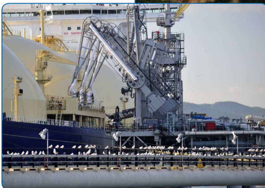
Газовоз во время погрузки СПГ, 2010 год Gas carrier during LNG loading, 2010
