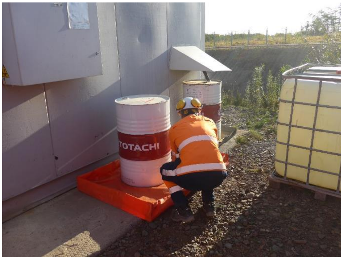
Фото 25. Бочка с отработанным маслом, установленная на переносной поддон с частично упавшими бортами (на снимке запечатлен процесс исправления проблемы после замечания аудитора).
