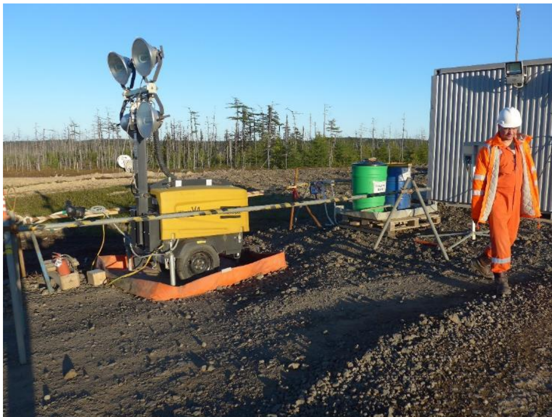
Фото 22. Пример вторичного средства локализации для генератора и бочек с маслом.
