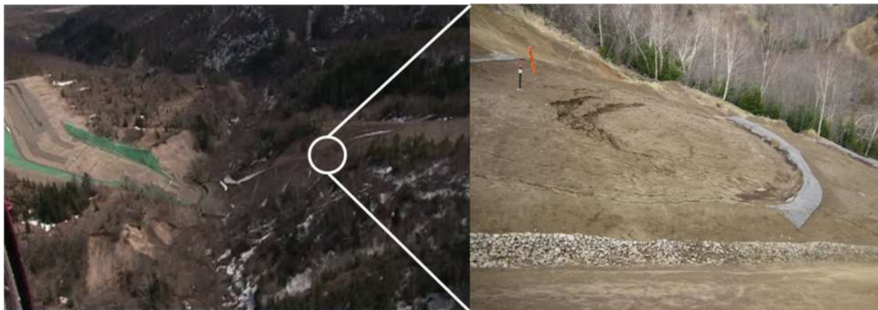
Фото 39. Видеокадр и фото участка обрушения склона на реке Седлец.
