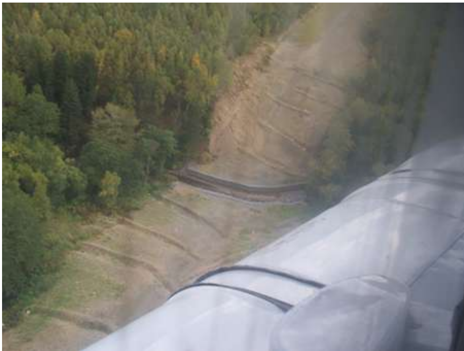
Фото 6 Скудная растительность – типичная ситуация в полосе отвода. Методы защиты склонов и реки эффективны, несмотря на недостаточный растительный покров.
