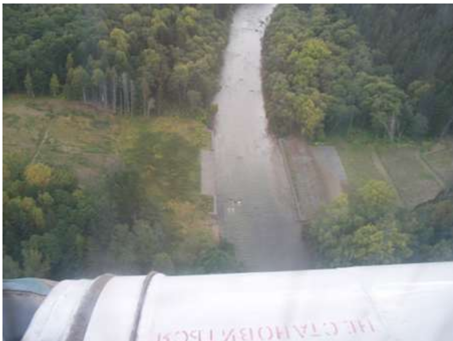
Фото 2 Типичная картина рекультивационных мероприятий на реке. Габионы и матрасы Рено оказались весьма эффективными; просадка на правом берегу говорит о высоте подъема потоков во время тайфунов.
