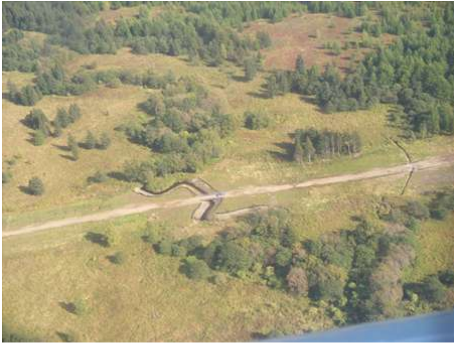
Фото 11 Множество оставленных временных мостов и проездных трасс позволяет транспорту местного населения проникать в полосу отвода (обратите внимание на синюю машину, приближающуюся к мосту). Кроме того, отметьте прекрасные результаты рекультивации, если не принимать во внимание остающуюся проездную трассу. Компания АЕА принимает в расчет, что «Сахалин Энерджи» будет продолжать демонтаж мостов и проездных трасс до конца сезона.
