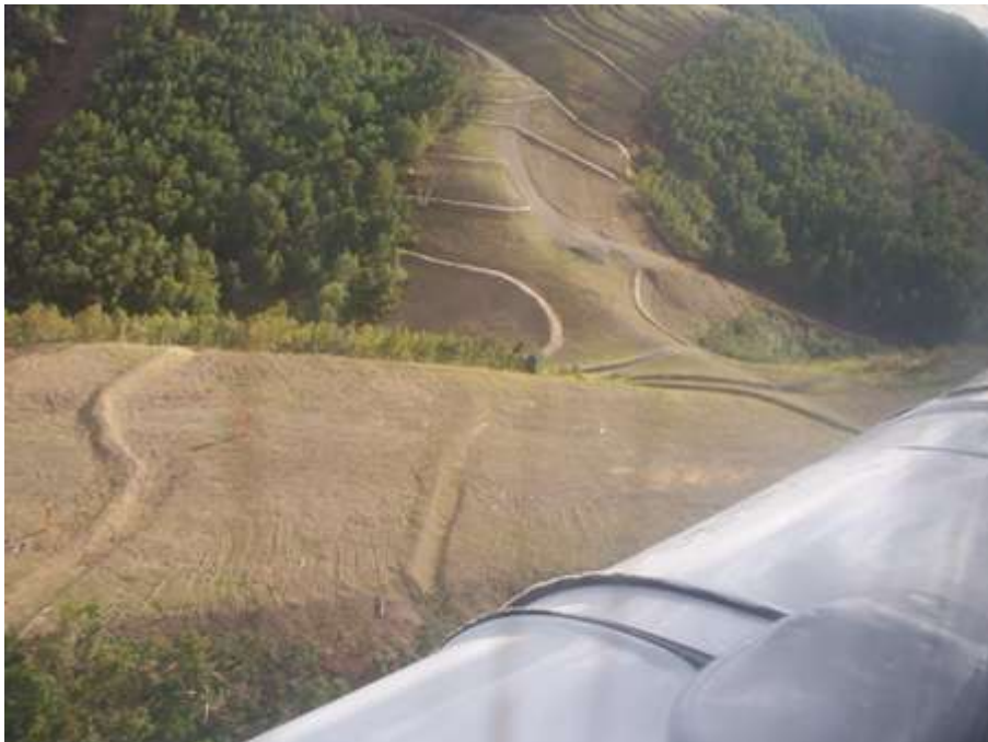
Фото 12 Типичная картина рекультивации. Склоны хорошо защищены от эрозии раскатками (в том числе, приводными), несмотря на скудную растительность.
