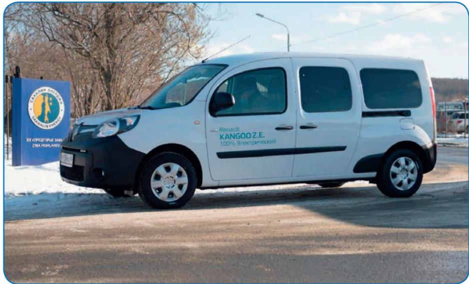
вращения блокировки колес при торможении, а также системой динамической стабилизации автомобиля, которая возвращает «железного коня» на курс при неуправляемом заносе. При скорости менее 30 км/ч срабатывает генератор шума — посредством воспроизведения звука машины с двигателем внутреннего сгорания он предупреждает пешеходов о приближении «электрички». Аккумуляторная батарея установлена в полу автомобиля и дополнительно защищена стальной рамой.
