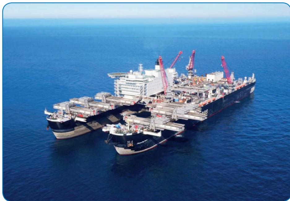
Для строительства глубоководного морского участка газопровода «Турецкий поток» использовалось крупнейшее в мире строительное судно Pioneer Spirit
