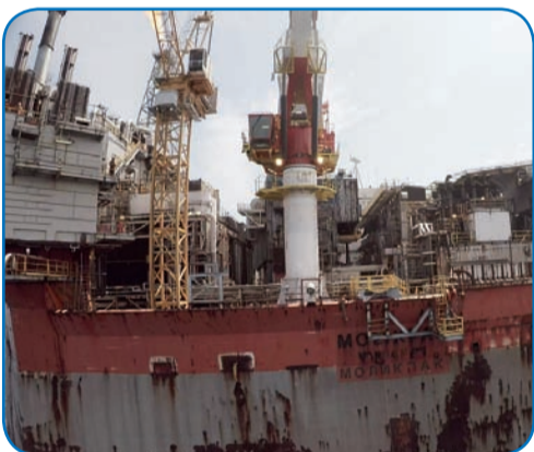
Временный башенный кран (слева) и новый кран № 3
