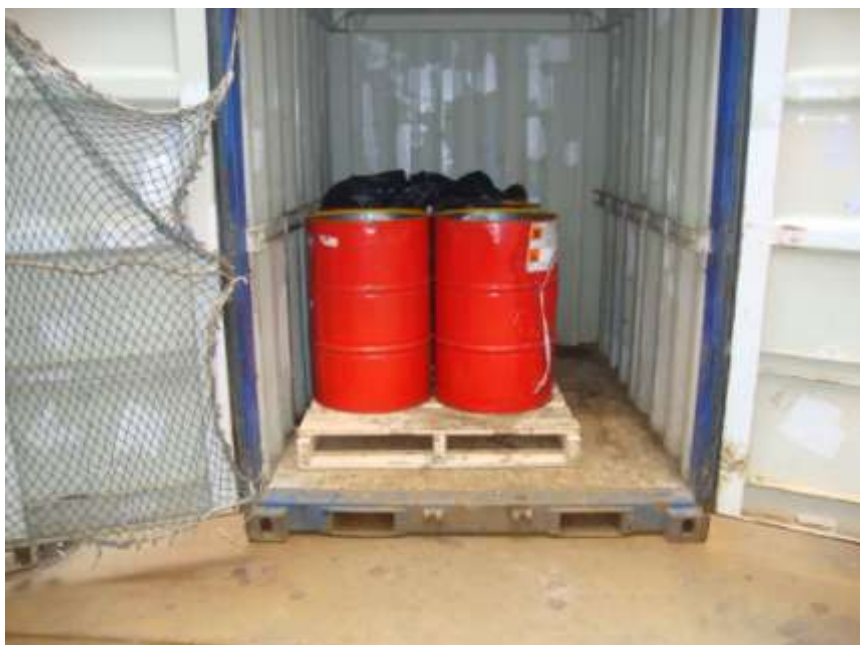
Фото 9. Отходы промасленной ветоши в мешках, в бочках, помещенных внутри грузового контейнера
