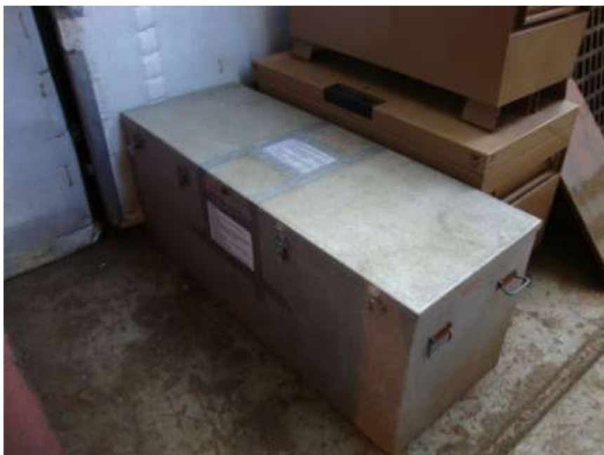
Фото 8. Отходы люминесцентных трубок в стальном ящике
