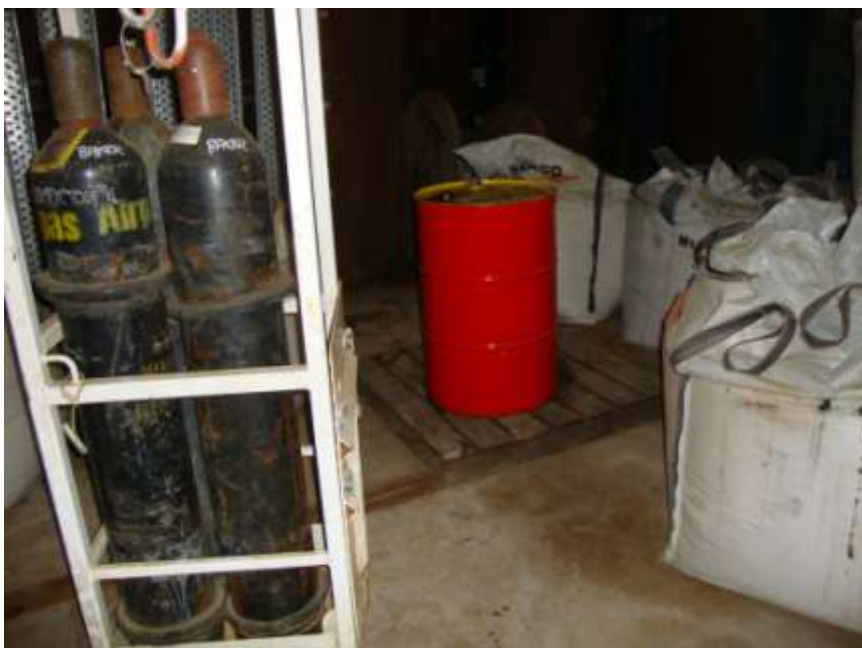
Фото 12. Бочка в зоне «ядра» без вторичной защитной оболочки
