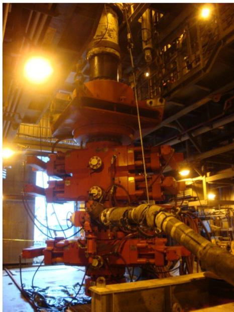
**Фото 19:** Планирование действий в аварийной ситуации – противовыбросовый превентор
