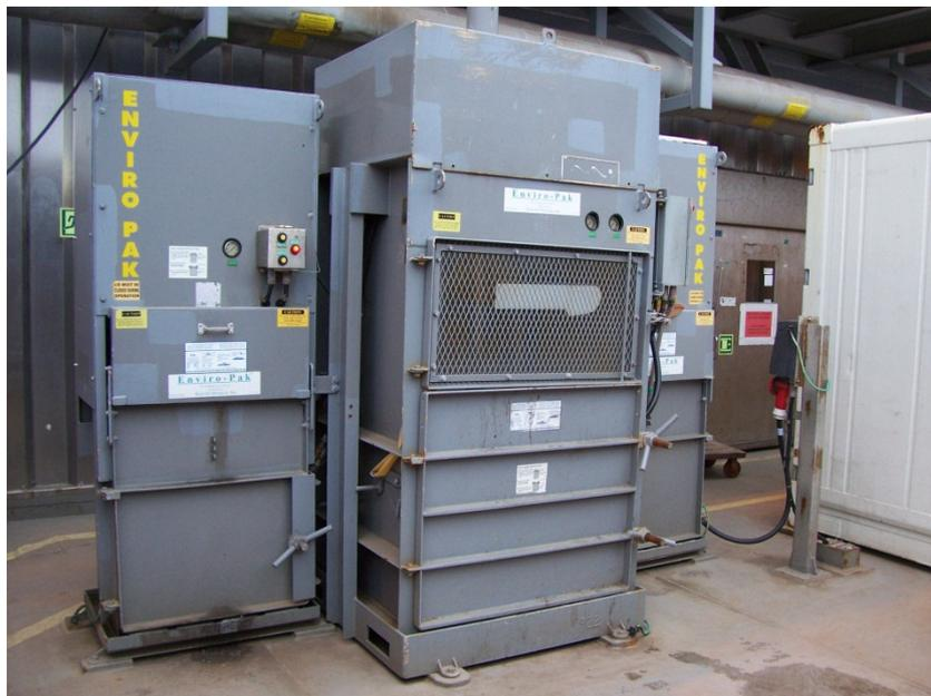
**Фото 10:** Компактор бытовых отходов
