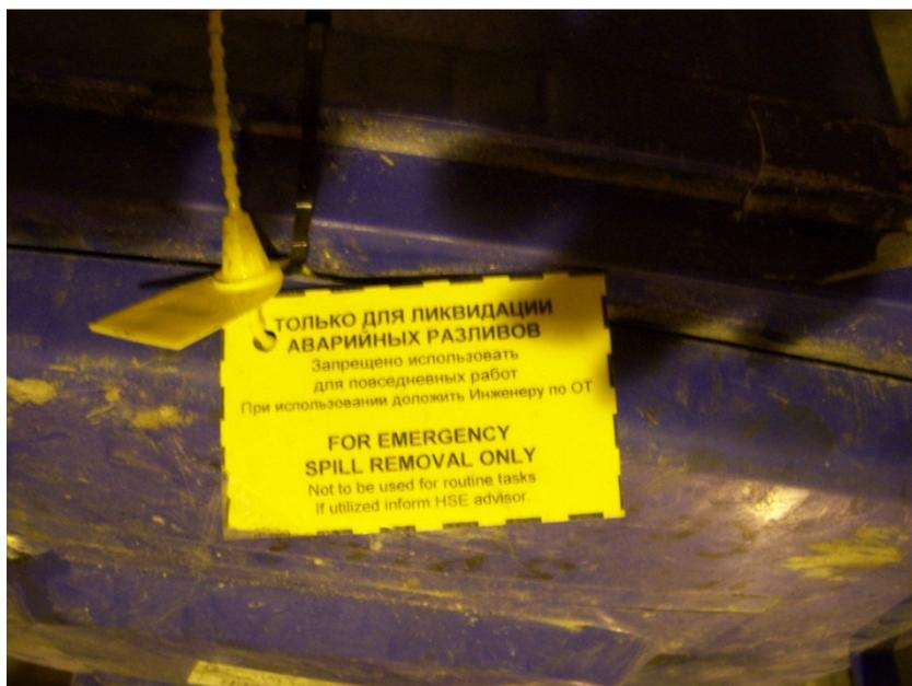
**Фото 20:** Закрытый пакет с приспособлениями для удаления разливов нефти – используется в случае аварии
