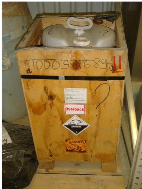
**Фото 10:** Бочка с неизвестной жидкостью и неправильным кодовым обозначением ее на складе С104
