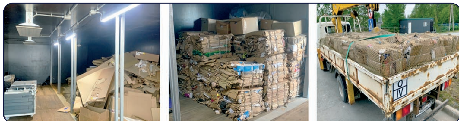
На территории комплекса оборудован участок для переработки и прессования бумаги и картона с использованием промышленного пресса. Благодаря этому вес транспортной партии отходов увеличен в три с половиной раза, что позволяет значительно сократить транспортные издержки
