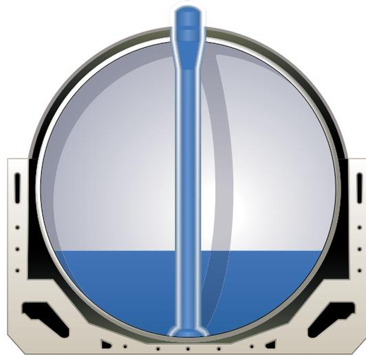
Устройство грузового танка типа «Мосс-Розенберг»
