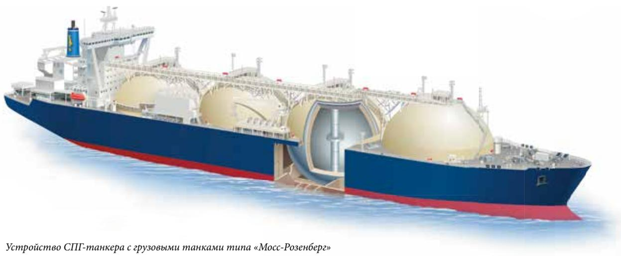
Устройство СПГ-танкера с грузовыми танками типа «Мосс-Розенберг»
